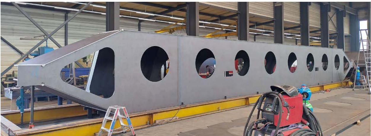
Die neuen Dammbalken sind als Schweißkonstruktion ausgeführt.
