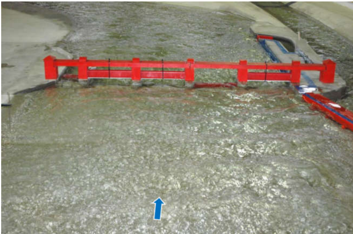
Abbildung 6: Physikalisches Modell 1 Bereich Wehr: Versuch HQ100 „n-1“ mit nicht gezogenem Schützenpaket am Wehrfeld 3; aus [1]
