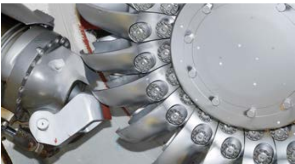
Versuchslaufrad mit beschichteten Laufradbechern
