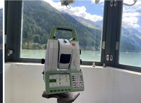
Laufendes Monitoring (24 h/7Tage) an der Dammkrone durch Talsperrenverantwortliche
