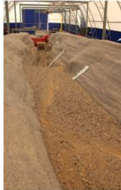
Das Bild zeigt die Geschiebeablagerung im Stauraum nach einem HQ100-Ereignis in Blickrichtung talauswärts/Richtung Wasserfassung.
