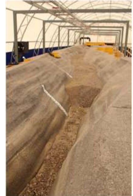
Das Bild zeigt die Geschiebeablagerung im Stauraum nach einem HQ100-Ereignis in Blickrichtung taleinwärts..
