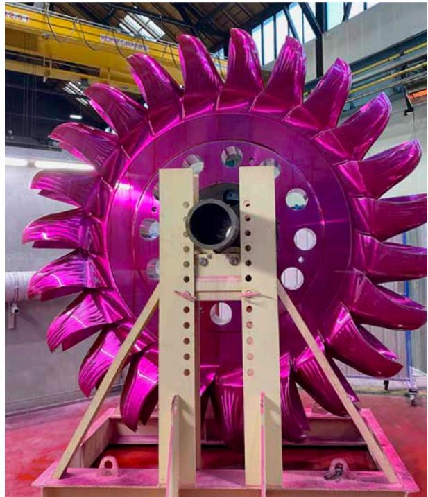
Das neue Laufblad bei der sogenannten Eindringprüfung
