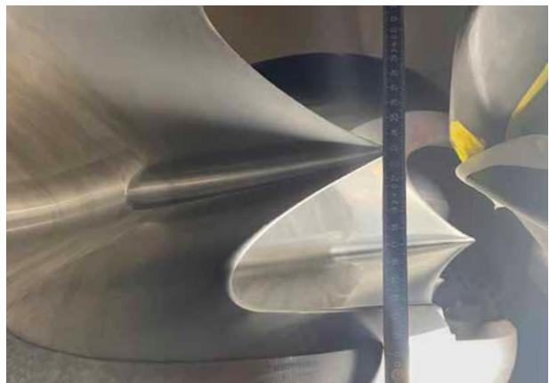
Auch nach rund 8.000 Arbeitsstunden lassen sich am bereits länger in Betrieb befindlichen Laufblad der Maschine 2 keine Abnutzungserscheinungen erkennen.
