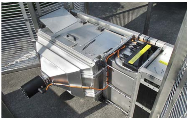
Riverwatcher bestehend aus Scanner-Einheit und Kamerasystem
